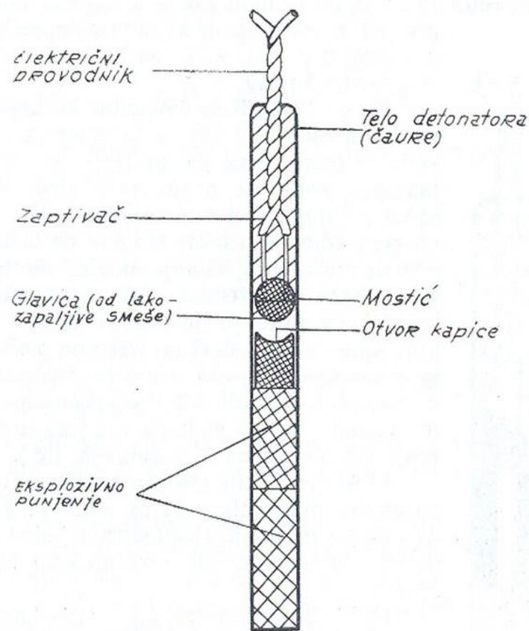
Sl. 10. Električna detonatorska kapsla EK-40-63
